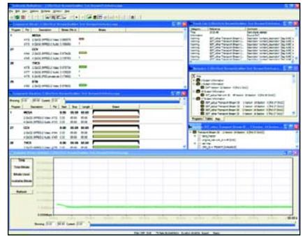
利用TSCA的实时双工运行和播放器，可以进行端到端的系统测试(输入和输出同时运行，最大平均比特率可达214bit/s)。<sup>1</sup>
