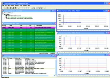
有两种类型的缓存器模式；接收机使用的一种模式是存在于基本流自身。T-STD 模式是基于 PES 头中的 DTS 值，它可用于任一种含有 CODEC 的类型。此外，某些视频 CODEC (例如 MPEG-2 和 H.264/AVC) 可能包含 ES 自身中的缓存器参数。缓存器分析仪验证 T-STD 模式码流的一致性。H.264/AVC HRD 方法的验证由 MTS4EA 产品所提供。
